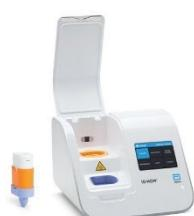
■RT-PCR 法は、結果判明が翌日夕刻になってしまいますが、本検査機器による NEAR 法は、ほぼ同等の精度 (Real time PCR 検査との陽性一致率 93.3%、陰性一致率 98.4%) で、検体を検査機器にセットしてから 13 分程度で結果が判明する、迅速性に優れた検査法です。2020 年 10 月 20 日に厚生労働省で正式に医療機器として承認されています。
